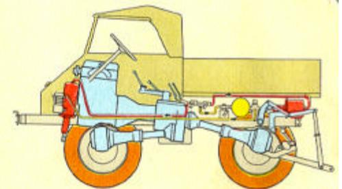
Anordnung Triebwerk u. Kraftheber
